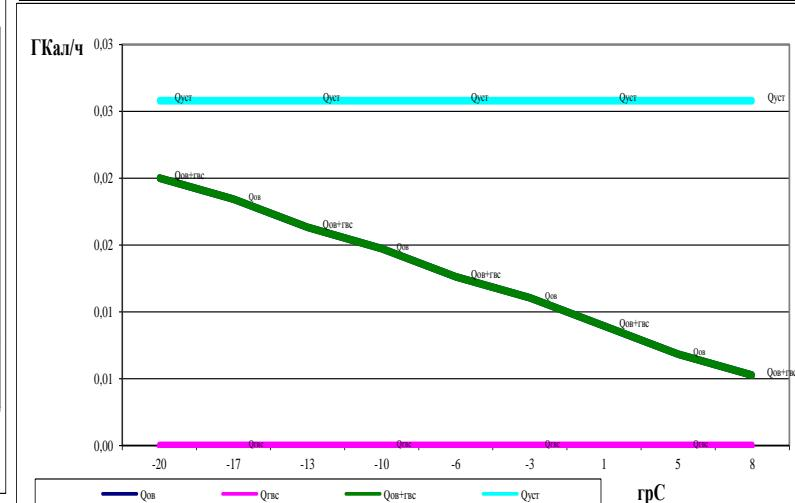
Теплопроизводительность источника тепл. энергии превышает необходимую на 0,01 Гкал/ч на существующее положение. Резерв тепловой мощности существующей котельной по сути перспективным нагрузкам составляет 0,01 Гкал/час.
