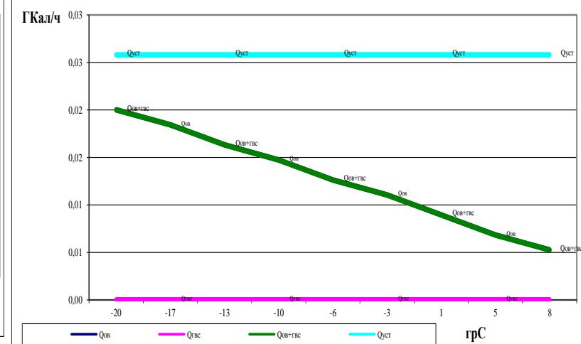
Теплопроизводительность источника тепл. энергии превышает необходимую на 0,01 Гкал/ч на существующее положение. Резерв тепловой мощности существующей котельной по существующим и перспективным нагрузкам составляет 0,01 Гкал/час.
