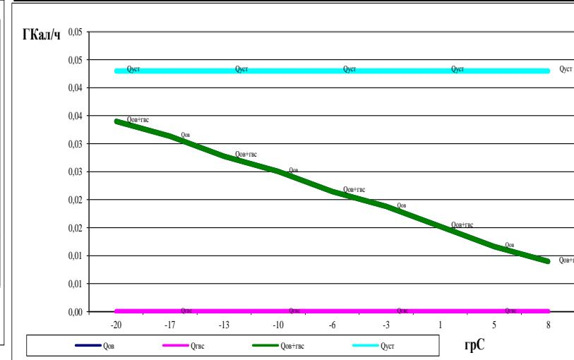
Теплопроизводительность источника тепл. энергии превышает необходимую на 0,01 Гкал/ч на существующее положение. . Резерв тепловой мощности существующей котельной по сущ.и перспективным нагрузкам составляет 0,01 Гкал/час.
